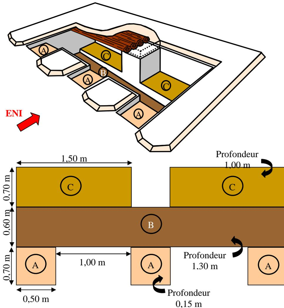
Cet emplacement est collectif et peut être utilisé quel que soit l'armement servi au sein du trinôme. Il est difficilement aménageable sans l'aide de moyens mécaniques du génie. Il offre les caractéristiques suivantes :
